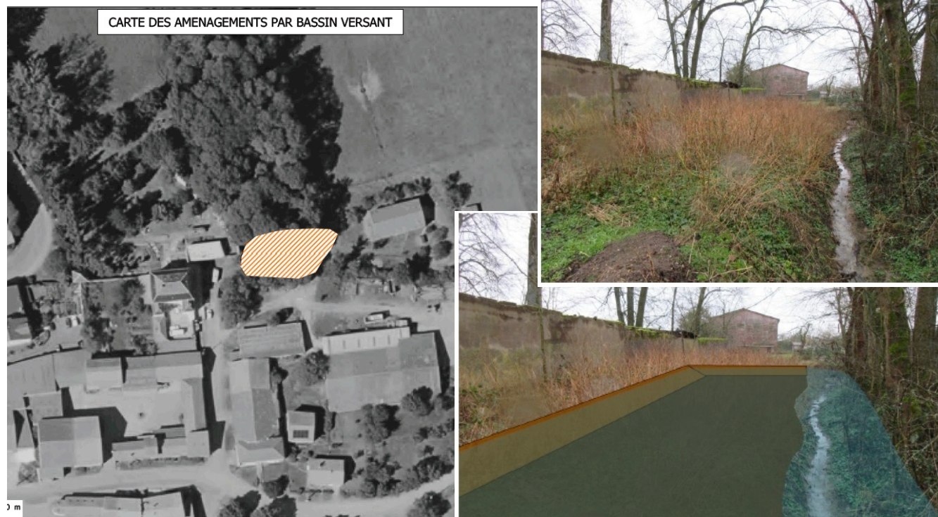
Figure 4 : Aménagement du BV n°2 - Déblaiement du lit majeur rive droite du cours d'eau (source : Artélia)
