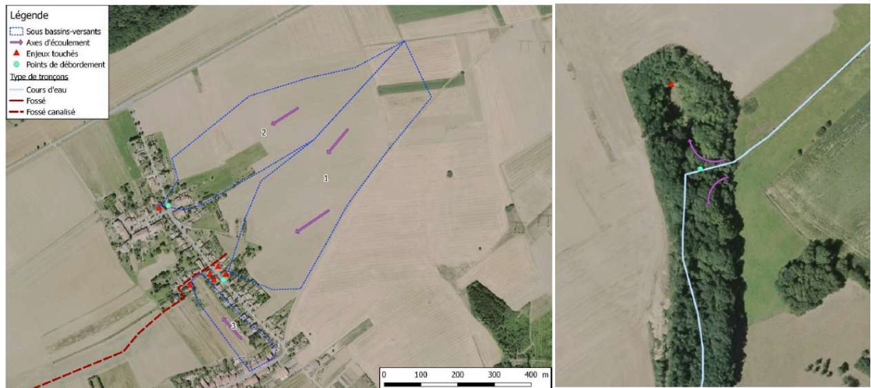
Carte 23 : Bassins versants de Servigny-lès-Sainte-Barbe (à gauche) et dysfonctionnement du tunnel de Failly (à droite) (source : Artélia)
